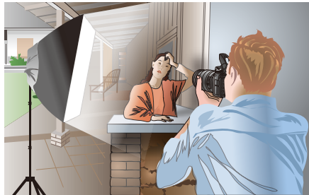
一部 SB-700 放置於可均勻散佈光線的便攜式柔光箱中，由 D610 的內置閃光燈無線啟動。
